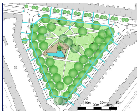
Waterplein, gedeeltelijk ondergelopen
